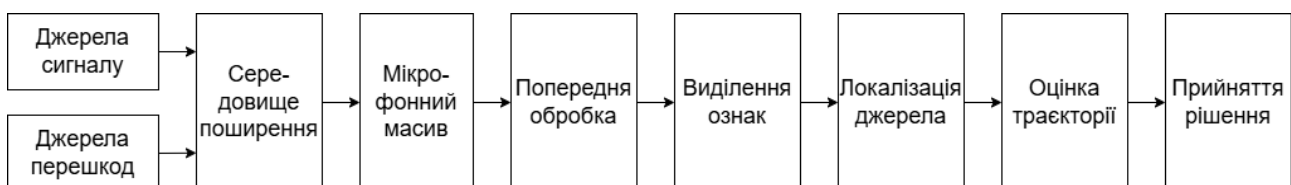
Рис. 1. Узагальнена структурна схема алгоритму акустичного виявлення та локалізації БПЛА
