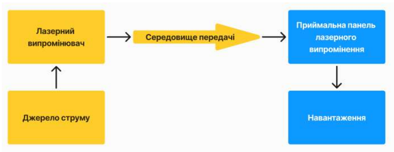
Рис. 2. Загальна структура системи бездротової лазерної передачі енергії.
