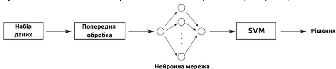
Рис. 5. Система розпізнавання на основі SVM-нейромережі
