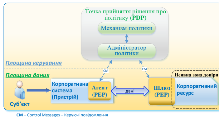
Рис. 3. Модель розгортання на основі агента пристрою/шлюзу
