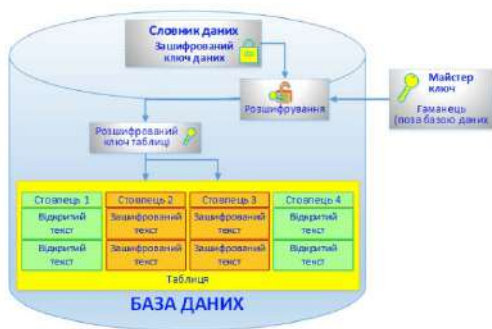
Рис. 2. Приклад прозорого шифрування даних в БД Oracle
