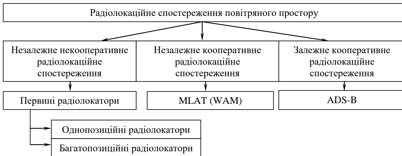
Рис. 1. Класифікація радіолокаційного спостереження повітряного простору
