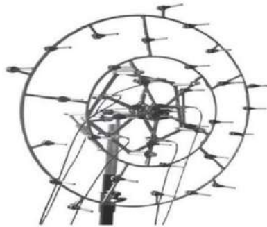
Рис. 1. Мікрофонна решітка BSWA-TECH SPS-980 [3]
