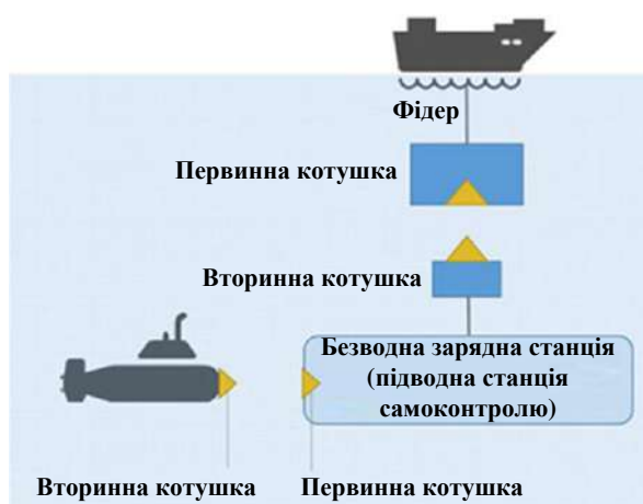
Рис. 5. Система БПЕ для живлення безпілотних підводних апаратів
