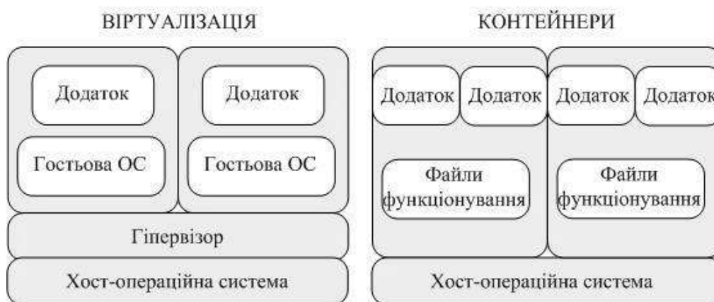
Рис. 5. Графічне порівняння віртуалізації та контейнеризації
