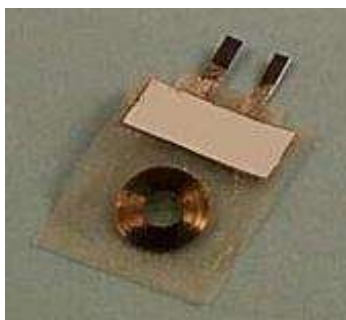
Рис. 3. Внешний вид температурного датчика ТЭП 018-05
