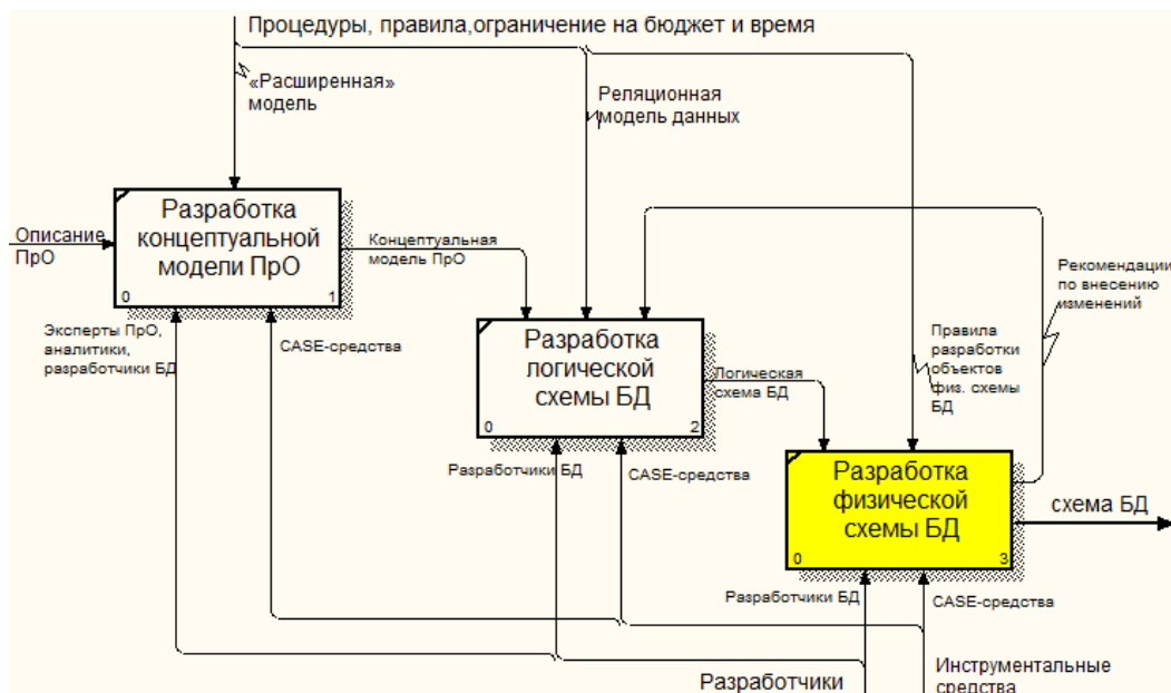
Рис. 1. Представление основных фаз традиционной технологии проектирования реляционных баз данных в нотации IDEF0
