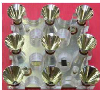
Рис. 9. Приемник концентрированного солнечного излучения на основе трехпереходных арсенид-галлиевых СЭ: a – фотография общего вида приемника с интегрированными ВОЭ; б – электрическая схема соединений
