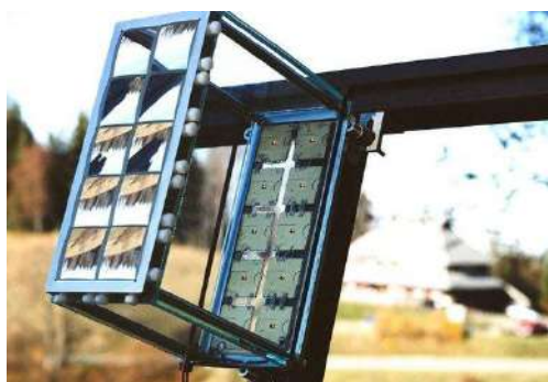
Рис. 6. Концентраторный модуль на двухосевом солнечном трекере
