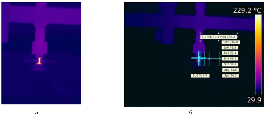
Рис. 8. Термограмма разогрева подложки из поликора с пленкой фоторезиста. Тепловое поле (а) и температуры в точках подложки Sp1...Sp7, расположенных по радиусу области с центром на кончике рабочего зонда Sp8 (б)
