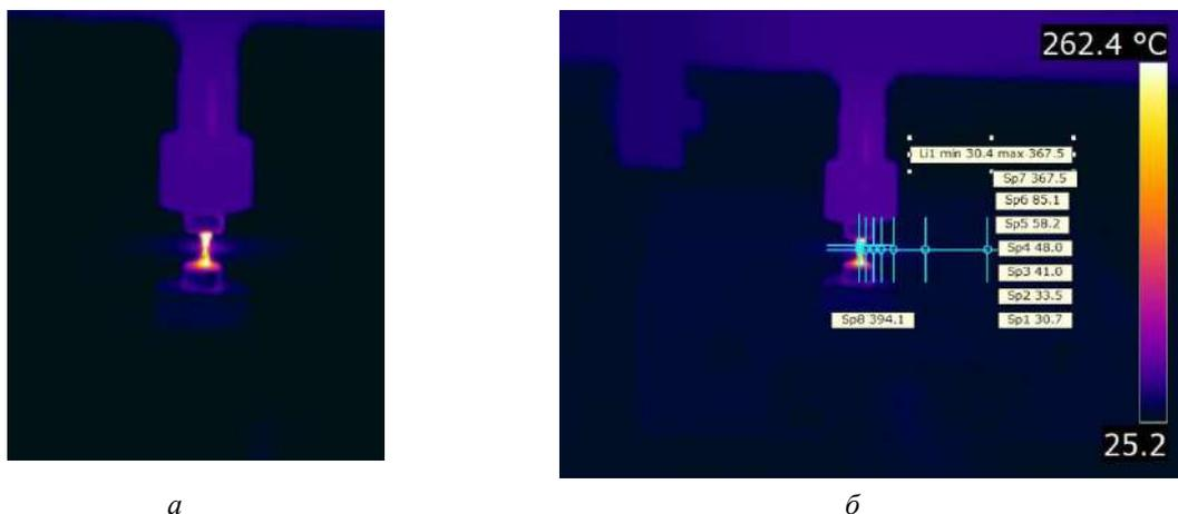
Рис. 9. Термограмма для случая касания зондом подложки из поликора с пленкой фоторезиста. Тепловое поле (а) и температуры в точках подложки Sp1...Sp7, расположенных по радиусу области с центром на кончике рабочего зонда Sp8 (б)
