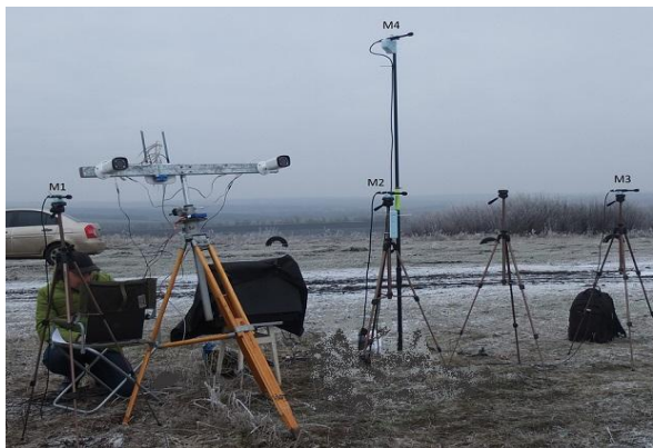
Рис. 9. Мікрофонна решітка М1-М4 пасивного содару
