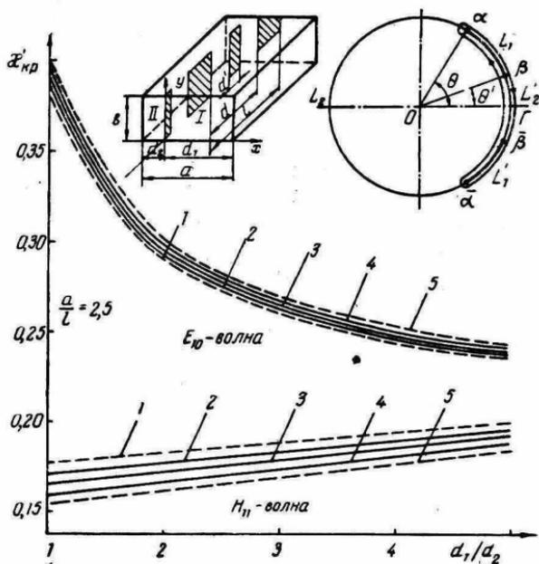
Рис. 2. Зависимость поперечных волновых чисел от положения решетки в волноводе:
