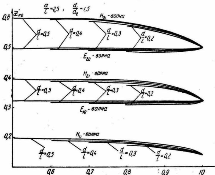
Рис. 1. Зависимость поперечных волновых чисел от коэффициента заполнения решетки.
