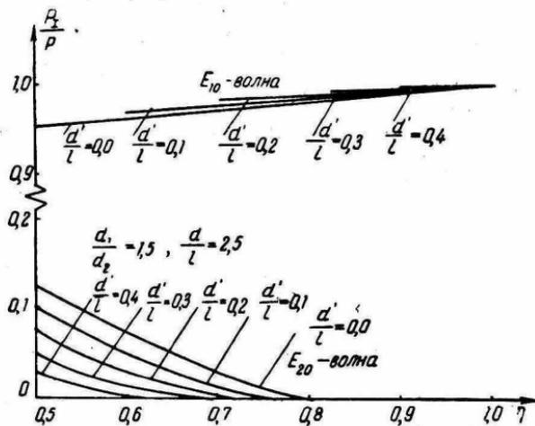
Рис. 3. Зависимость  $\frac{P_1}{P}$  от коэффициента заполнения решетки.
