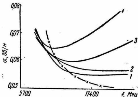
Рис. 2. Зависимость затухания волны  $cH_1$  в медном гофрированном волноводе ( $\sigma = 5,8 \text{ см/м}$ ) от глубины гофра для волноводов 1—4.
