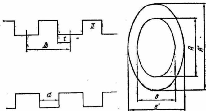
Рис. 1. Сечения эллиптического гофрированного волновода.
