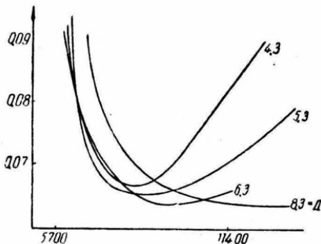
Рис. 3. Зависимость затухания от величины периода системы.
