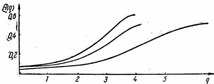
Рис. 2. Зависимость амплитуды высокочастотного напряжения от нормализованной длины лампы для потоков с  $\delta = 2\%$  и  $\delta = 32\%$  ( $\omega/\omega = 0,75$ ;  $d = 0$ ;  $b = 0$ ;  $D = 0,1$ ;  $r = 0,5$ ).
