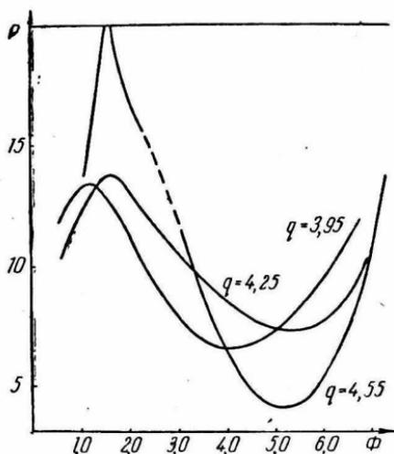
Рис. 3. Фазовые траектории электронов потока с  $h/a = 0,32$  ( $\omega_c/\omega = 0,75$ ;  $d = 0$ ;  $b = 0$ ;  $D = 0,1$ ;  $r = 0,5$ ).
