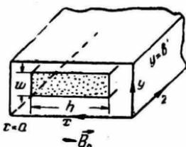
Рис. 1. Пространство взаимодействия и электронный поток трехмерной ЛБВМ.
