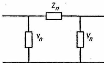
Рис. 2. П-образный симметричный четырехполюсник.
