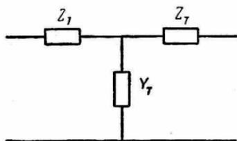
Рис. 1. Т-образный симметричный четырехполюсник.
