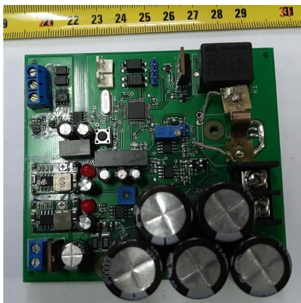
Рис. 6. Внешний вид блока питания лазерной светодиодной линейки
