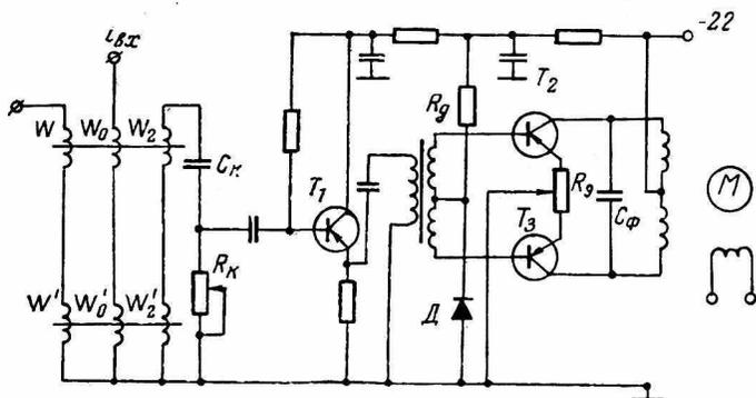
При подаче на соответствующим образом сфазированные входные обмотки управляющего сигнала постоянного тока нарушается симметрия кривой намагничивания. У магнитного потока и у тока резонансного контура появляются четные гармоники. При изменении полярности входного сигнала фазы четных гармоник потока и тока изменяются на  $180^\circ$ , фазы же нечетных гармоник остаются неизменными.
