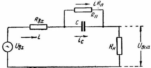
Рис. 2. RC — цепь, где выходным параметром является ток.
