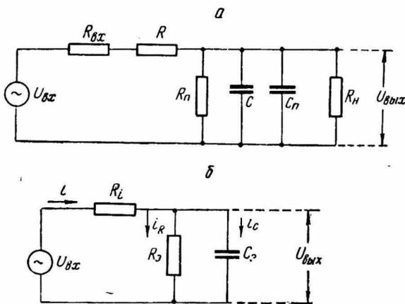
Рис. 1.  $RC$  — цепь, где выходным параметром является напряжение до (а) и после преобразований (б).
