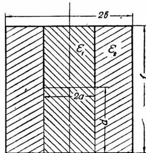
Рис. 1. Осевое сечение исследуемого резонатора.
