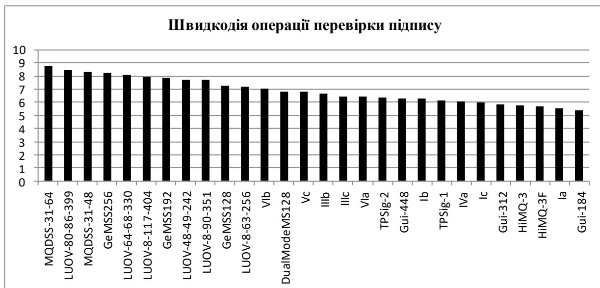
Рис. 9. Гістограма порівнювального аналізу показників швидкодії операції перевірки підпису (циклів у логарифмічному масштабі) для алгоритмів електронного підпису
